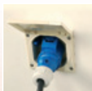
gniazdko, 230V/12V zapewnia zasilanie w przyczepie
