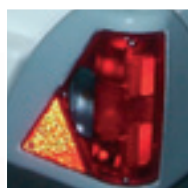
lampa ze zintegro- wanym światłem przeciwmgiełnym
